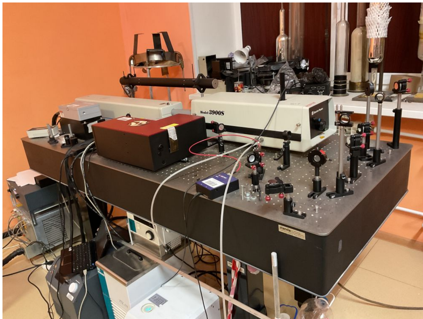
Лазерный стенд. Перестраиваемый лазеры используются для оптической накачки полупроводниковых структур. Фото Н. Лесковой.
