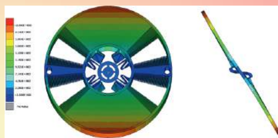
Форма колебаний чувствительного элемента микромеханического вибрационного гироскопа RR-типа
