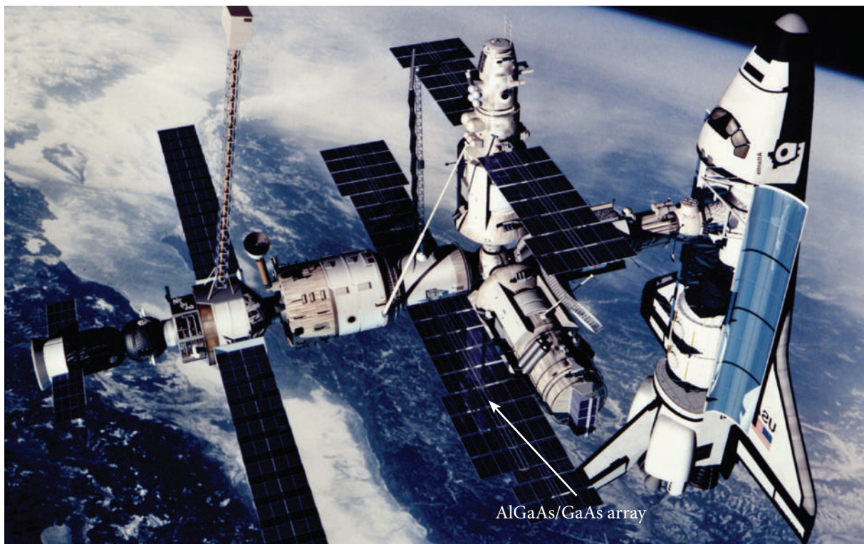
Фотоэлектрическая батарея, изготовленная НПО «Квант», с AlGaAs/GaAs СЭ (технологическая разработка гетероструктур — ФТИ им. А. Ф. Иоффе) в составе командного модуля космической станции «МИР» (выведен на орбиту 13 марта 1986 г.)
