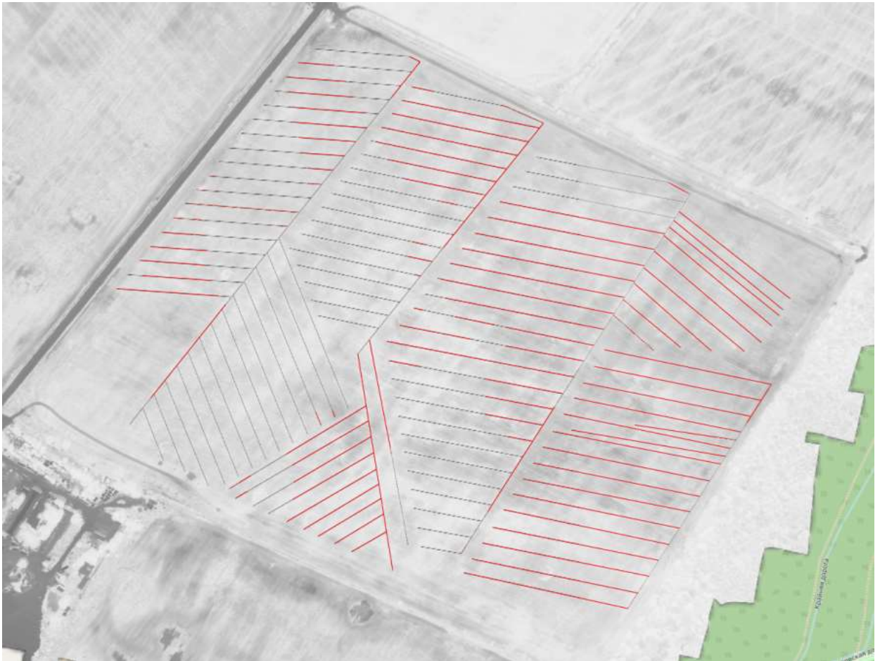
Рисунок 4. Геореференсированная схема дренажа, восстановленная по данным аэрофотозондирования [7]
