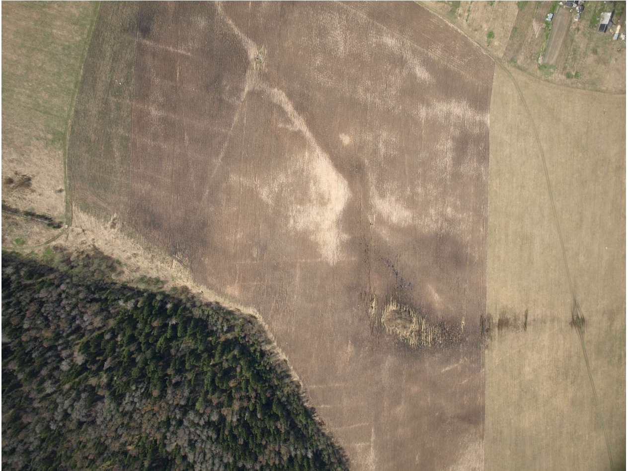
Рисунок 1. Аэрофотоснимок агромелиоративного состояния осушаемого угодья и нарушений ЗК-11 и МЗК-1
