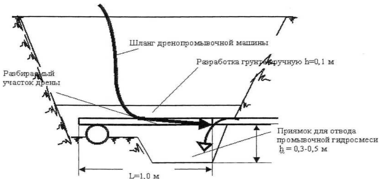
Рисунок 14. Схема промывки дрены в месте подключения к коллектору [12]
