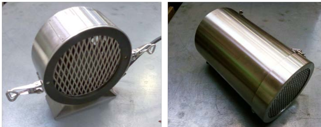
Рис. 16. Вентилятор (слева) и кассета с химическим поглотителем блока очистки
