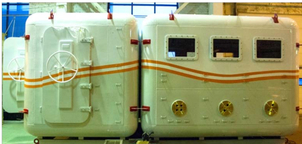
Рис. 11. Корпус барокамеры БКПД-1 в цехе предприятия
