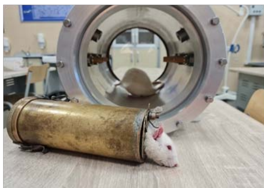
Рис. 28. Животное в металлическом капсуле (имитация ВКК)
