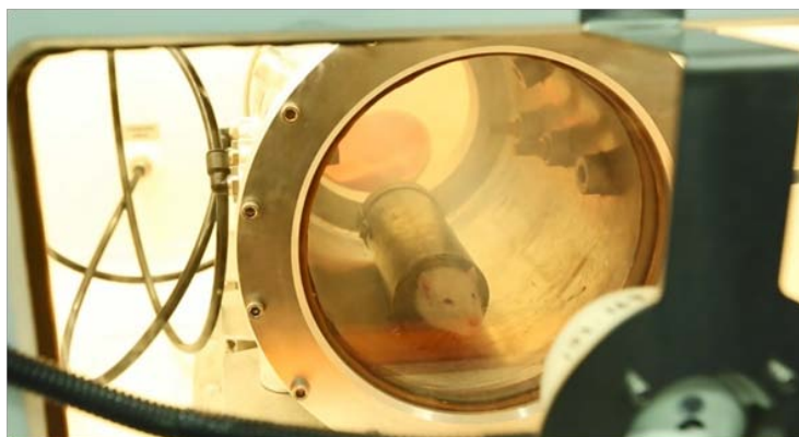
Рис. 30. Момент проведения взрывной декомпрессии (разгерметизации)
