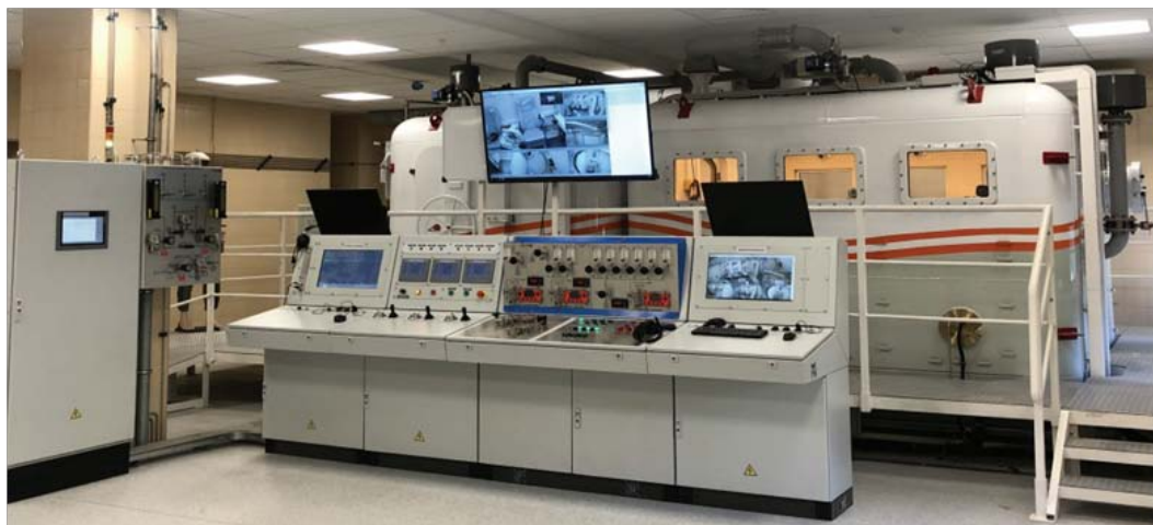
Рис. 13. Единый пульт управления барокамеры БКПД
