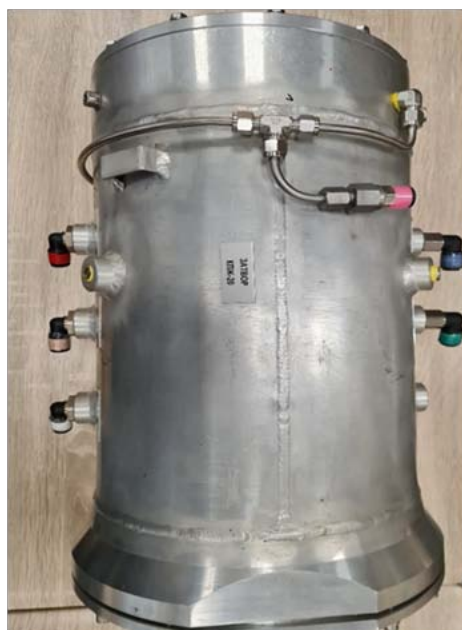
Рис. 24. Разъемы системы газобеспечения капсулы КПЖ-20
