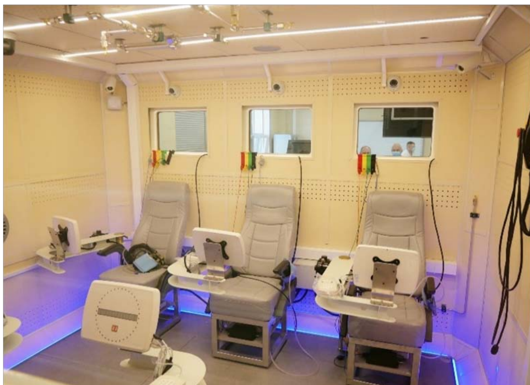
Рис. 12. Барокамера БПКД-1. Внутреннее оборудование
