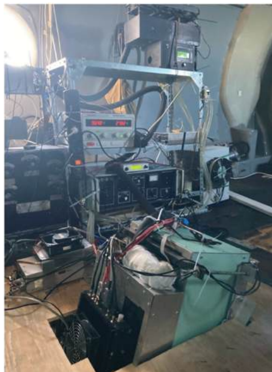
Рис. 3.7. Вид лидара АПЛ-4: справа — блоки лидара, размещенные в салоне самолета-лаборатории; слева — оптический блок лидара (вид со стороны оптического люка самолета-лаборатории)
