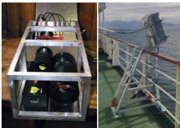
Рис. 3.6. Вид лидара ПЛД-1. Слева — оптический блок лидара ПЛД-1. Справа — оптический блок лидара, укрепленный на устройстве наведения
