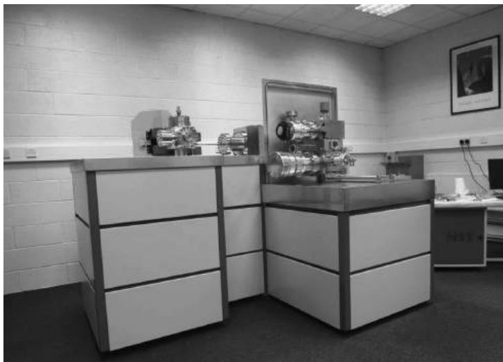
Рис. 2.8. Внешний вид магнитного масс-спектрометра для высокотемпературных термодинамических исследований с эффузионной камерой Кнудсена фирмы Mass Spectrometry Instruments Ltd., Великобритания [63]
