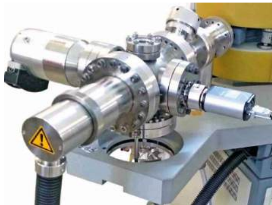
Рис. 2.9. Ионный источник модифицированного масс-спектрометра МТИ 350 Г с системой откачки, вакуумметром и смотровым окном [3]
